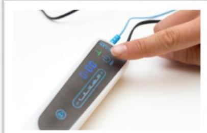
2. Essa é a aparência do equipamento quando o eletrodo está conectado corretamente.
